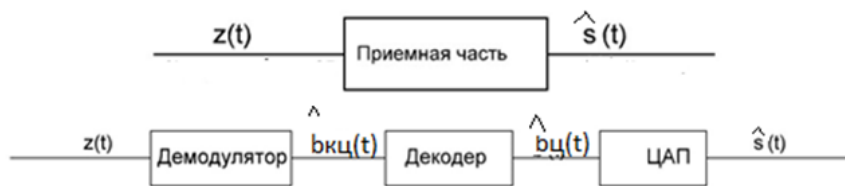
Рисунок 5. Функциональная схема приемника
