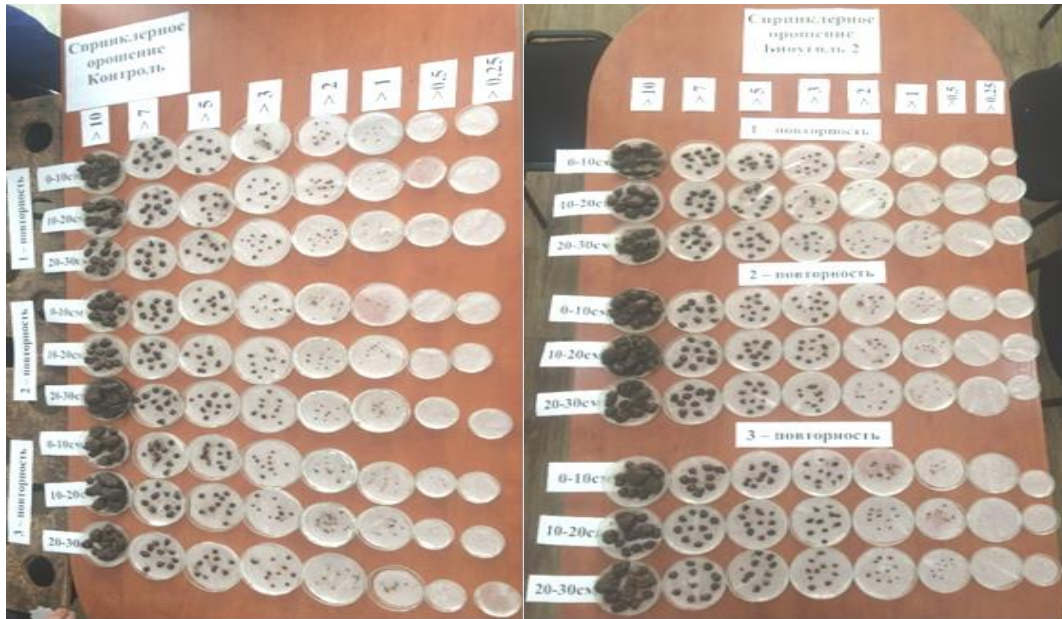
Сурет 1 - Топырақтың суға агрегаттарының суға төзімділігін анықтау
