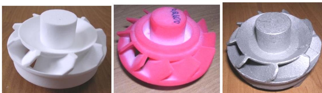
3-сурет. Полистирольді модель: а - "өсіруден" кейін; б-инфльтрациядан кейін; в-шойын құю
