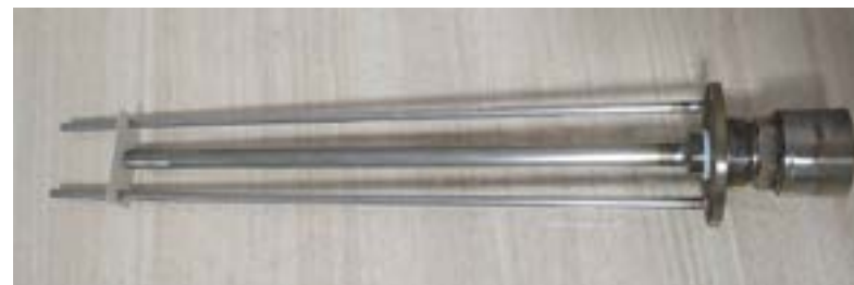
Рисунок 3 – Экспериментальный образец измерителя уровня улучшенной конструкции
